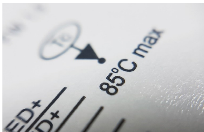
Figura 2 – Ponto Tc do Driver para medição de temperatura.
